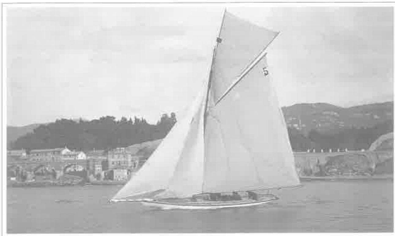
di corsa eccellenti. È un fin keel, ma per gli slanci e per l'affinamento del piano di deriva si avvicina al tipo fin bulb" (S. "Il varo di 'Melisenda'", *RN*, n. 4, aprile 1903). "Lunghezza massima 12,25 m, lunghezza al galleggiamento 8,20 m, larghezza 2,95 m, perimetro 6,64 m, superficie sezione maestra 1,42 m<sup>2</sup>, superficie velica 117,81 m<sup>2</sup>" (S., "Le corse della Coppa d'Italia", *Annuario RYCI*, 1912).
