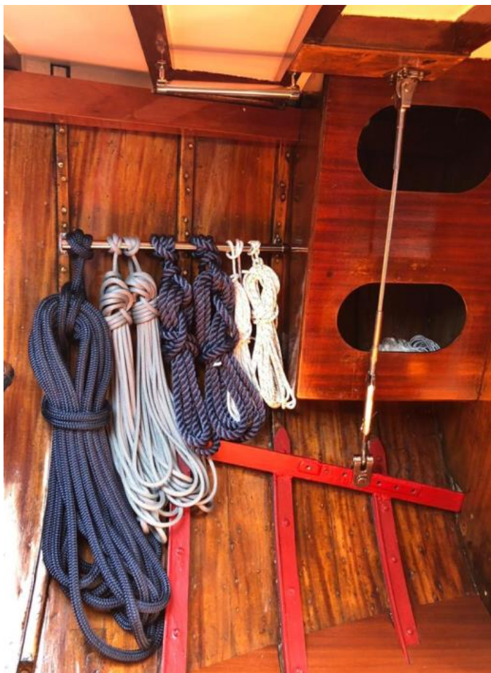
In rosso la struttura metallica che consente di scaricare in chiglia gli sforzi trasmessi dalle sartie, cui è collegata con il cavo inox visibile sulla destra
