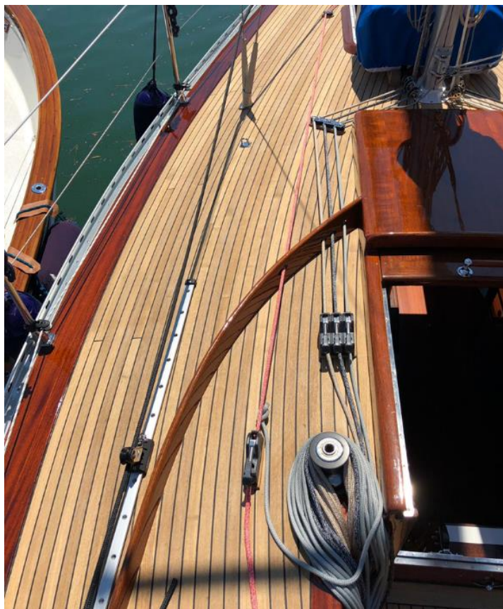
Particolare della coperta di Mä Vista. Il ponte è in teak mentre le parti verniciate a coppale sono in mogano
